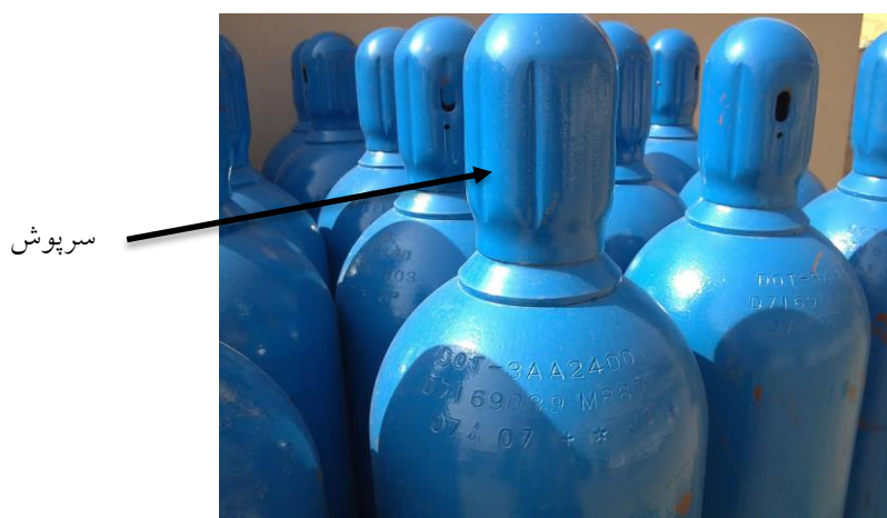
شکل ۴-۲۳: سیلندر گاز با سرپوش مخصوص
