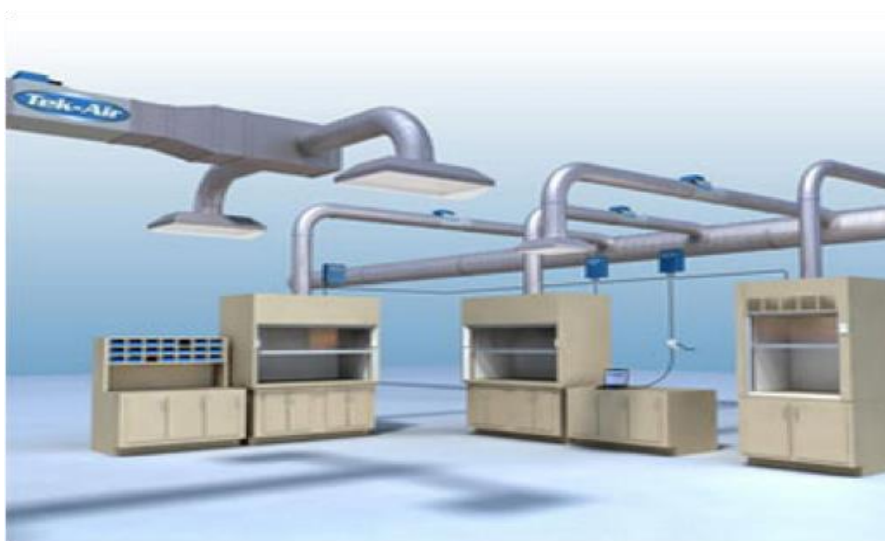
شکل ۱-۳۰ سیستم تهویه و هود
